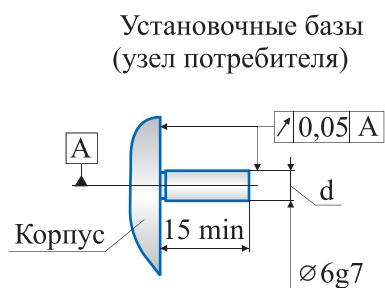
Возможна поставка адаптера (по чертежам заказчика) для соединения узла потребителя с преобразователем.
