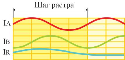
Сигнал IA опережает сигнал IB при вращении вала в направлении, указанному на габаритных чертежах (прямой ход).
