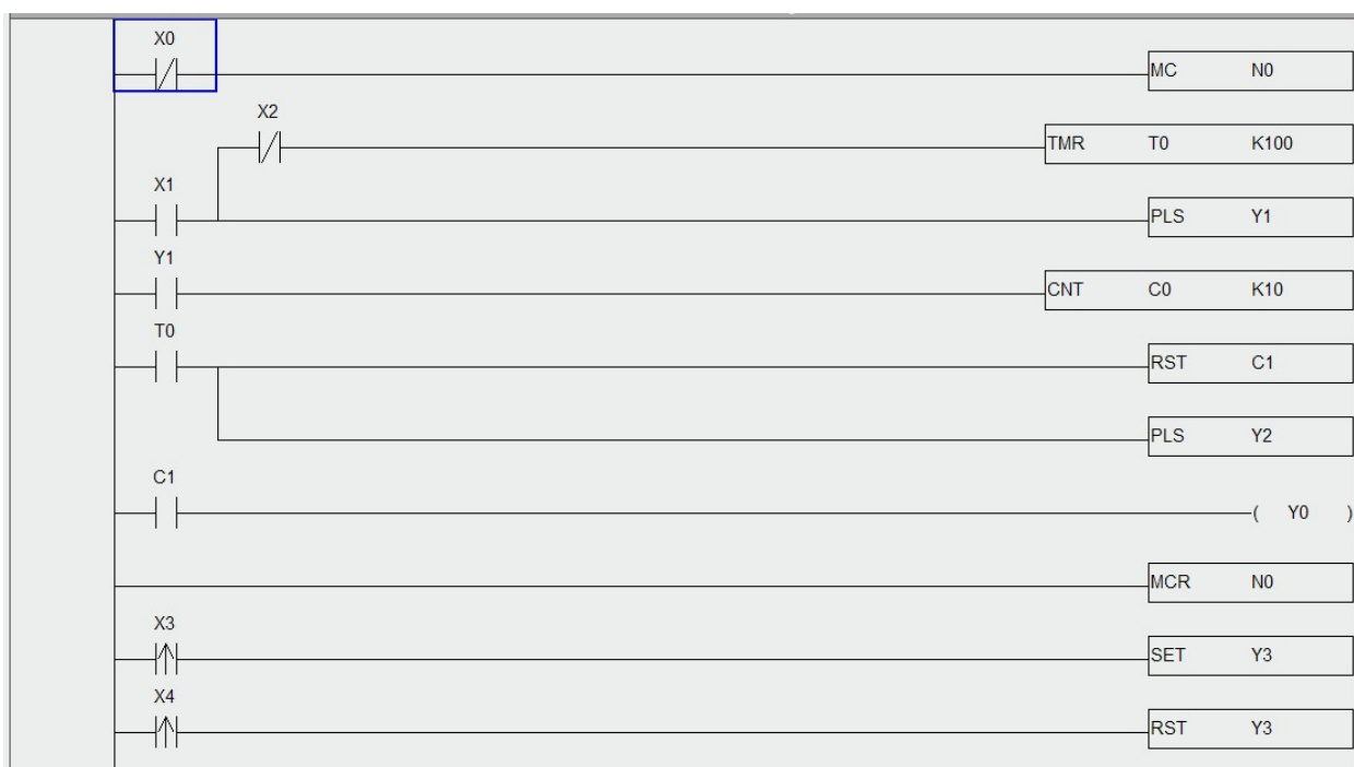
4.13. Добавление отключаемого блока.
