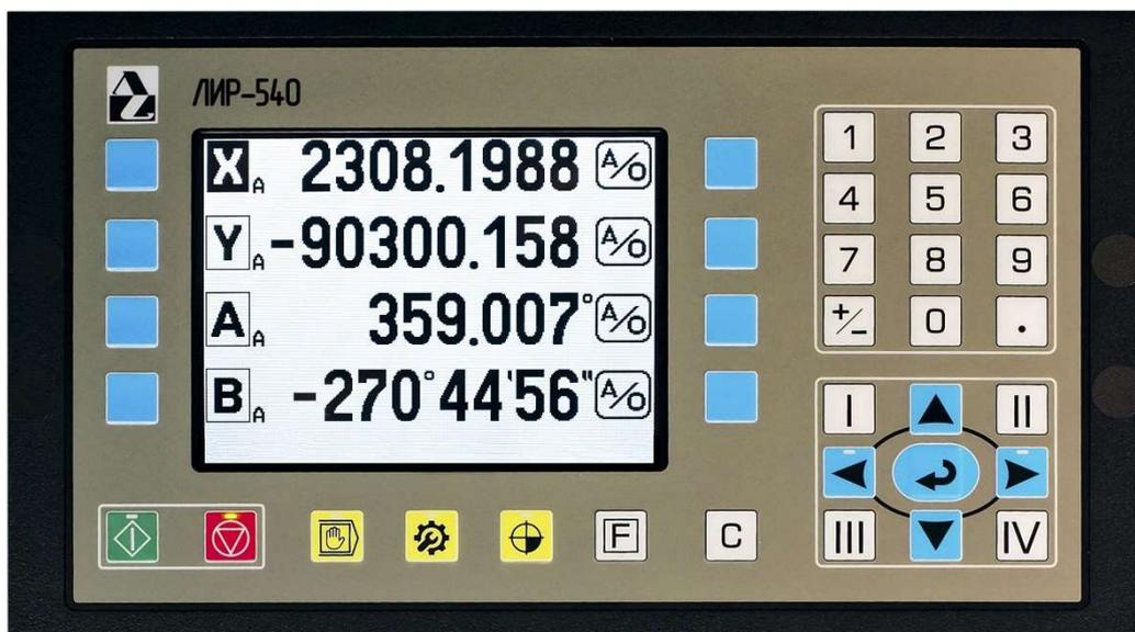
Устройство Цифровой Индикации
