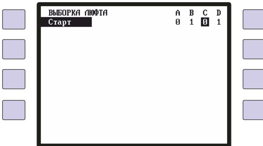
В параметре **«Выборка люфта»** устанавливается начальная скорость движения оси, для которой включен режим выборки люфта. Установленное в этом параметре значение скорости подачи, действует от начала движения оси и до появления первых импульсов с преобразователя перемещений. При появлении импульсов, скорость подачи переключается на значение, установленное в строке **«Старт»** в параметре **«Подача G1»** или **«Ускоренный ход G0»** для данной оси.
