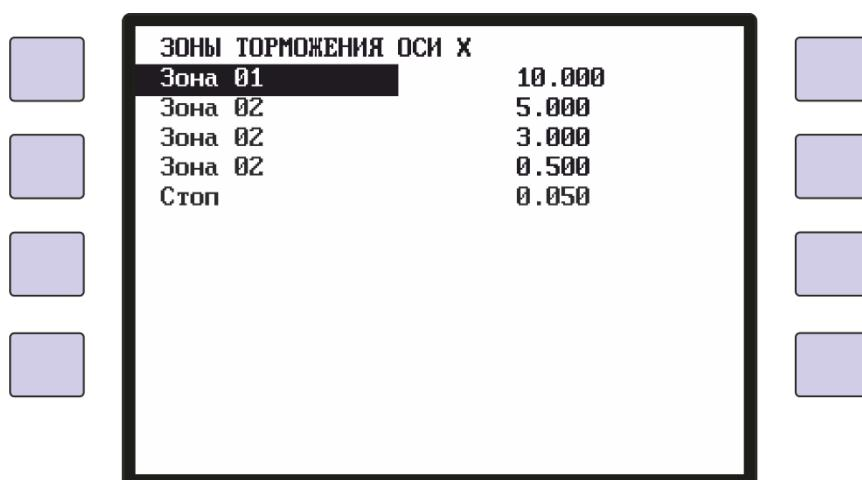
В данном параметре вводятся, в миллиметрах или градусах, расстояния до конечной точки позиционирования - зоны, на которых происходит переключение скоростей, установленных в [«Параметры оси→Зоны скорости»](#) для режима подачи (G0) или ускоренного хода (G1).
