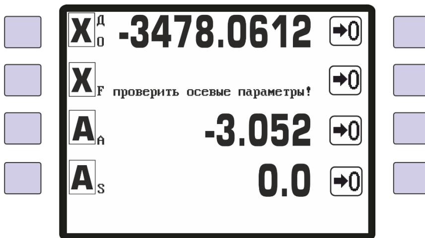
Например, на первой строке координаты линейной оси с названием **X**, на второй строке выведена скорость подачи оси с названием **X**. На третьей строке координаты линейной оси с названием **A**, а под координатой оси **A** можно вывести индикацию скорости вращения оси **A** (см. Параметры оси).
