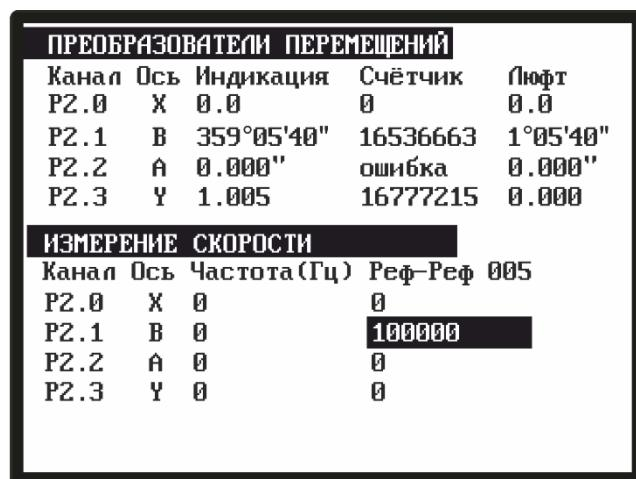
На экране отображаются номера разъемов и назначенные наименования осей.
