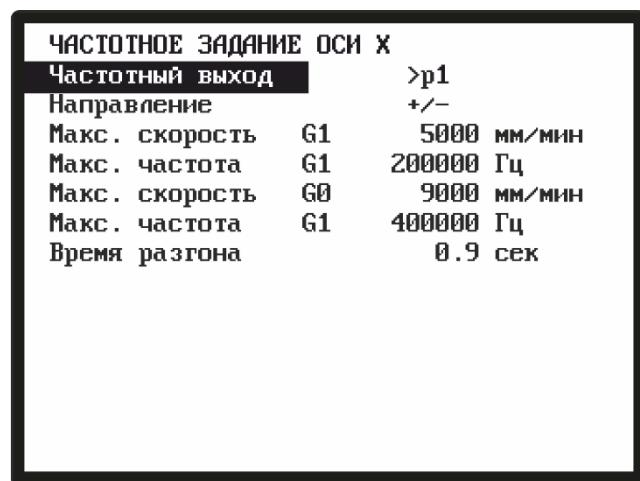
**Частотный выход** – кнопками и выбирается частотный выход пульта - **p1** или **p2** или контроллера ЛИР986А - **a1** или **a2**.
