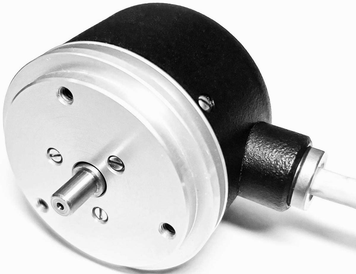
Преобразователи ЛИР-СИ-158 предназначены для измерения угловых перемещений валов различных устройств и механизмов. Принцип действия основан на эффекте периодической модуляции потока оптического излучения двумя установленными с зазором растровыми шкалами, одна из которых перемещается, а вторая неподвижна, и последующего опико-электронного преобразования модулированного излучения в электрические сигналы как периодические функции перемещения подвижной шкалы.
